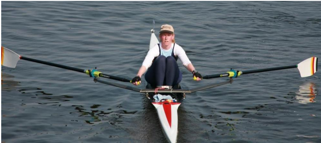
Skiffhead op de Amstel. Wedstrijdskiff met vleugelrigger (wing) Wedstrijdriemen met asymmetrische bladen (Fat Smoothies met Vortex Edge)
