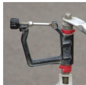
Klikringetjes onder en boven de dol
